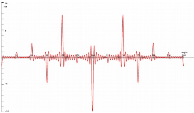
Abb 5. Korrelationsfunktion H_{i,j} 7. Ordnung nach Gleichung (10) mit N=7 . Die höheren Ordnungen der Korrelationsfunktion eignen sich für Resonanzprobleme.
